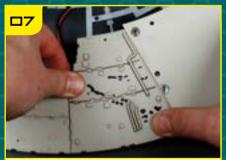
Установите ТР-09 поверх ТР-08 и опорной пластины блока для батарей.
