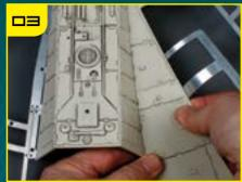
Установите TP-04 поверх фрагмента TP-05 и края обшивки коридора.
