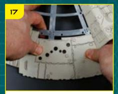
Установите TP-15 поверх TP-13 и края обшивки коридора.
