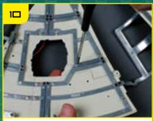
Зафиксируйте TP-10 с помощью винтов.
