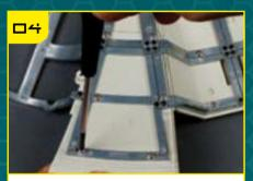
Зафиксируйте TP-04 с помощью винтов. Обратите внимание, как фрагмент выступает за край каркаса.
