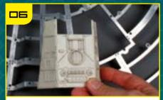
Установите фрагмент обшивки коридора левого борта TP-17 на внешнем радиусе каркаса.
