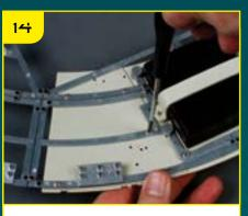
Зафиксируйте TP-12 с помощью винтов.
